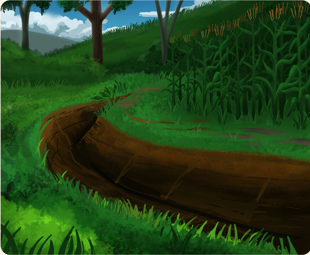
Zanjas de infiltración
