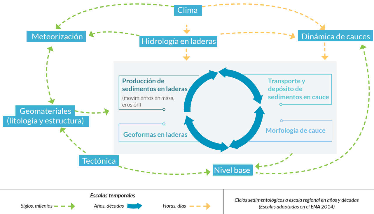
• Figura 49. Componentes del ciclo de sedimentos en diferentes escalas temporales y espaciales. Fuente: tomado del ENA 2014, modificado de (Preston & Schmidt, 2003).
