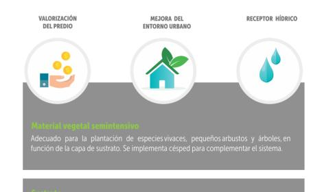
El sustrato semintensivo puede estar compuesto por turba o fibra de coco, arcilla triturada o cocida, subproductos vegetales y material mineral como arena de sílice.
