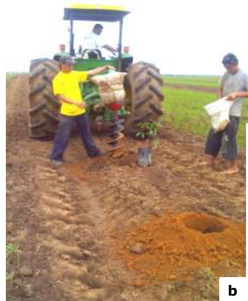
Figura 18. Ahoyado a. Proceso manual de ahoyado para la siembra de caucho en su sitio definitivo; b. Ahoyado con barreno mecánico.
