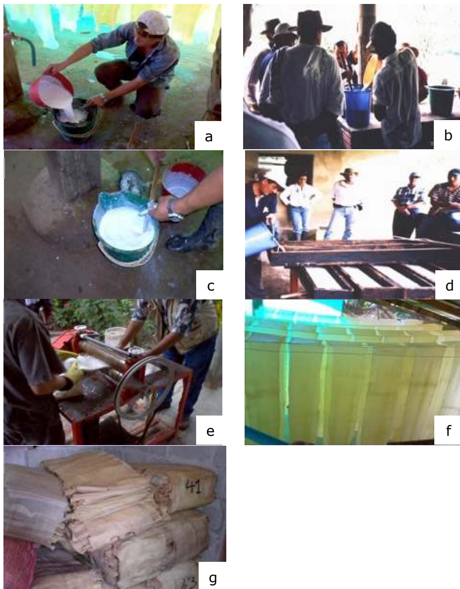
Figura 63. Pasos Fen la producción de láminas secas. a. Filtrado; b. Dilución; c. Acidificación; d. Coagulación; e. Laminado; f. Secado; g. Empacado. Fuente: FNFC (2006)
