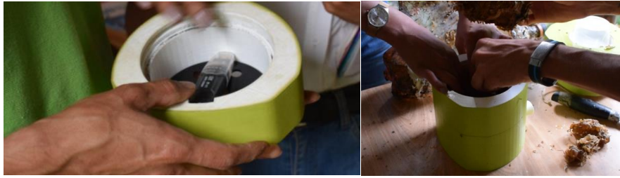
Figura 46. Instalación de Datalogger interior colmena
