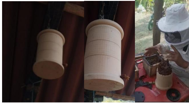
Figura 36. Banco de pruebas del material PLA con 15% de fibras de madera
