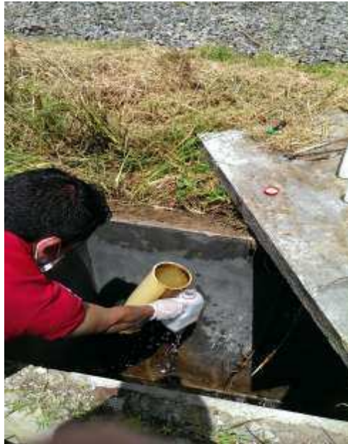
Figura 22. Toma de Muestra a la salida del Humedal Artificial
