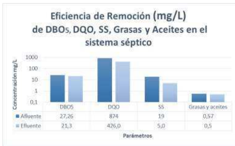
Figura 38. Eficiencia de Remoción de contaminantes fisicoquímicos en el Filtro Anaerobio de Flujo Ascendente
