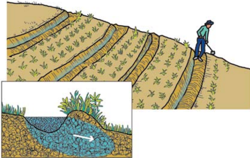
Figura 7: anja de contorno o zanja de infiltración
