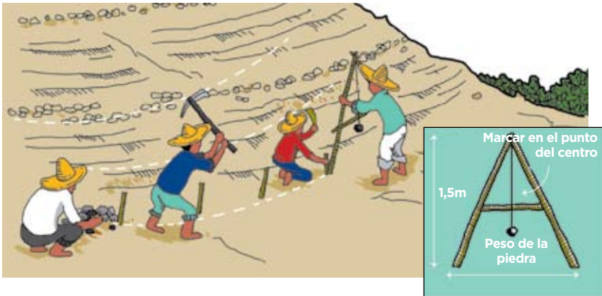
Figura 9: Uso de un nivel A para marcar el contorno
