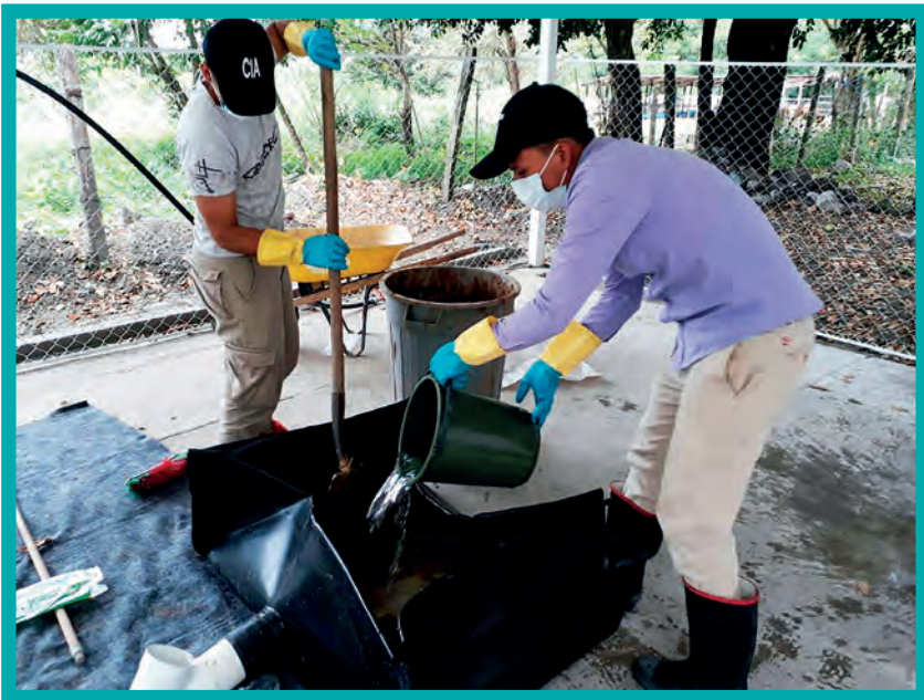
Carga del biodigestor
