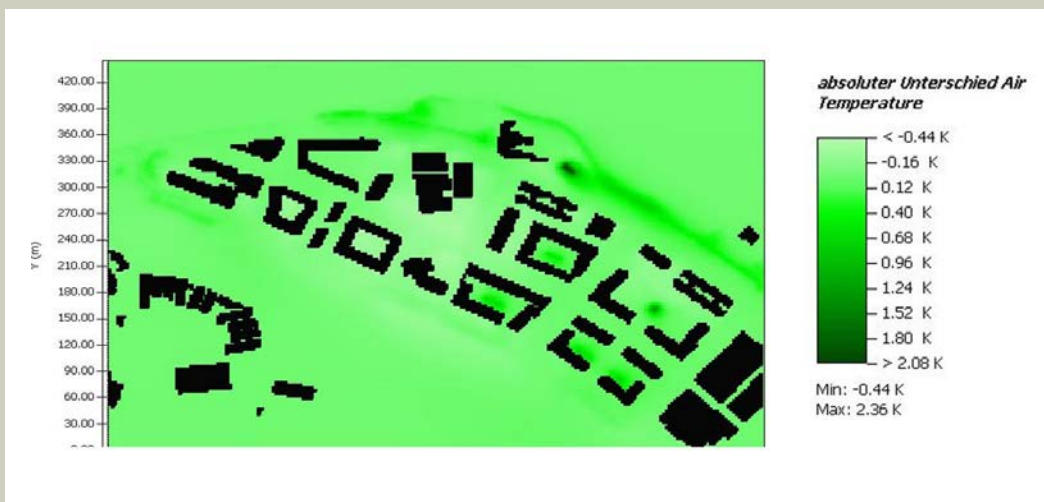
Figura 16. Mapa de temperatura del aire comparativo de las alternativas de diseño actual y factible.
