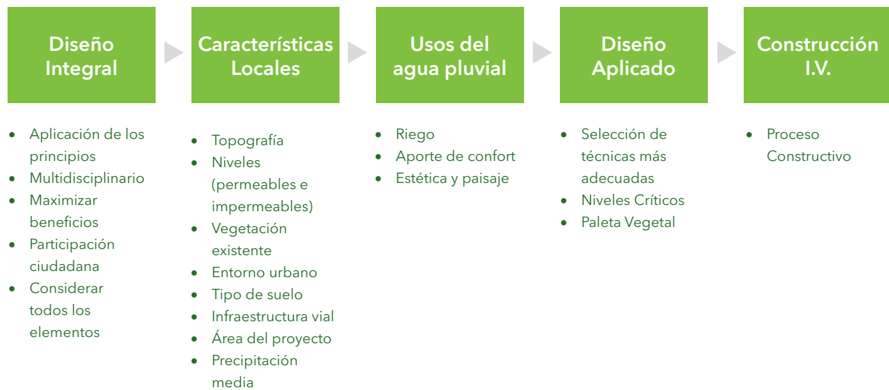
Figura 4. Pasos generales del proceso de diseño de I.V.
