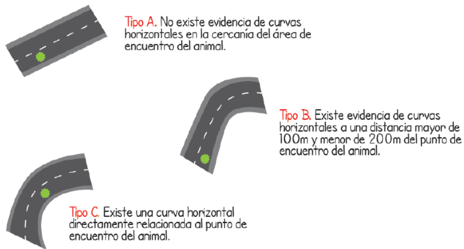
Figura 6. Tipos de curvatura de carretera referente a la ubicación de las alcantarillas y pasos aéreos ubicados en Ruta 4, Sección Bajos de Chilamate – Vuelta Kooper (Fuente: Pomareda et al. , 2014)
