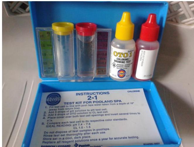
Figura 26.- Kit para la determinación del pH y cloro residual en el agua.
