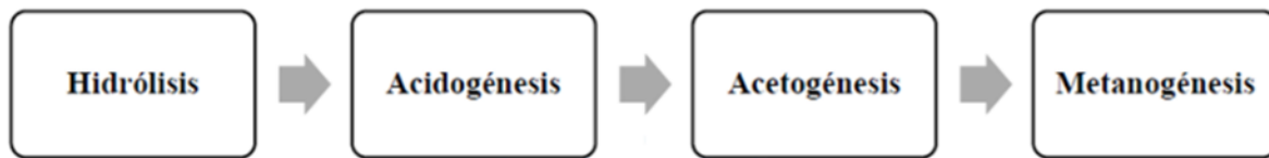
Fig. 2. Esquema simplificado secuencial del proceso de biodigestión anaerobia
