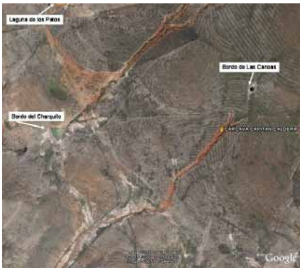
Figura 1. Imagen satelital del área de trabajo. Se aprecia la zona de influencia de la cárcava intervenida en 2005-2006 con cerramiento, reforestación y zanjas derivadoras en curvas a nivel. Fuente: Google Earth.
