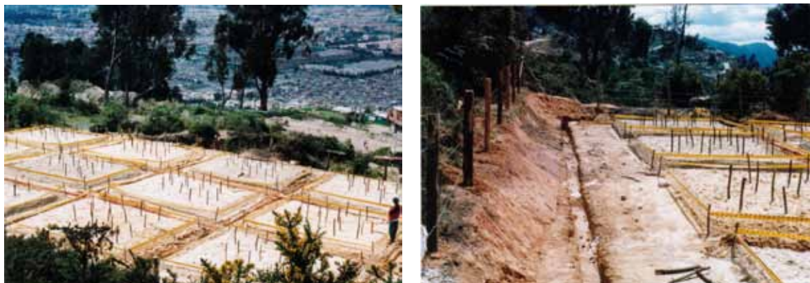
Figura 2. Área experimental al inicio del experimento. Izquierda: Panorámica del área experimental. Derecha: Detalle de la adecuación de las zanjas perimetrales para evitar el aporte de sedimentos de las áreas adyacentes.
