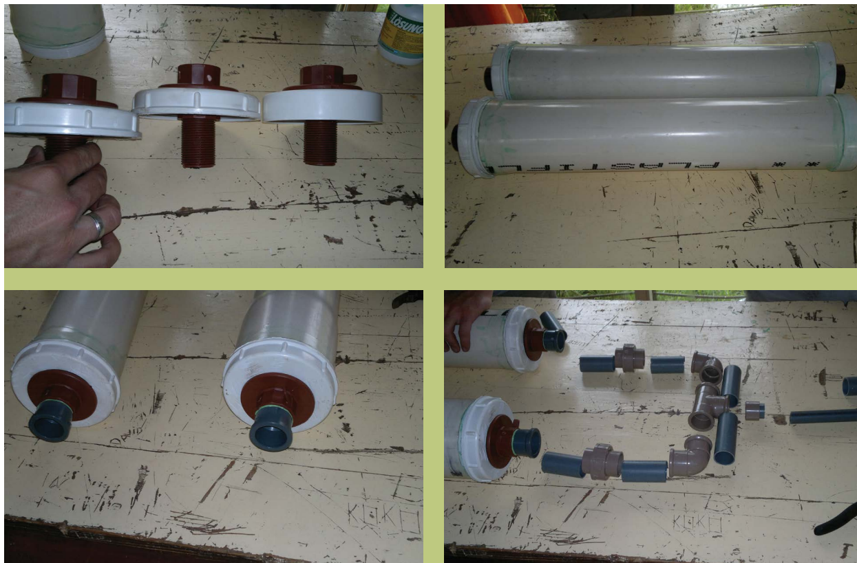
Imagen 29. Fases del armado de un filtro de sulfhídrico domiciliario
