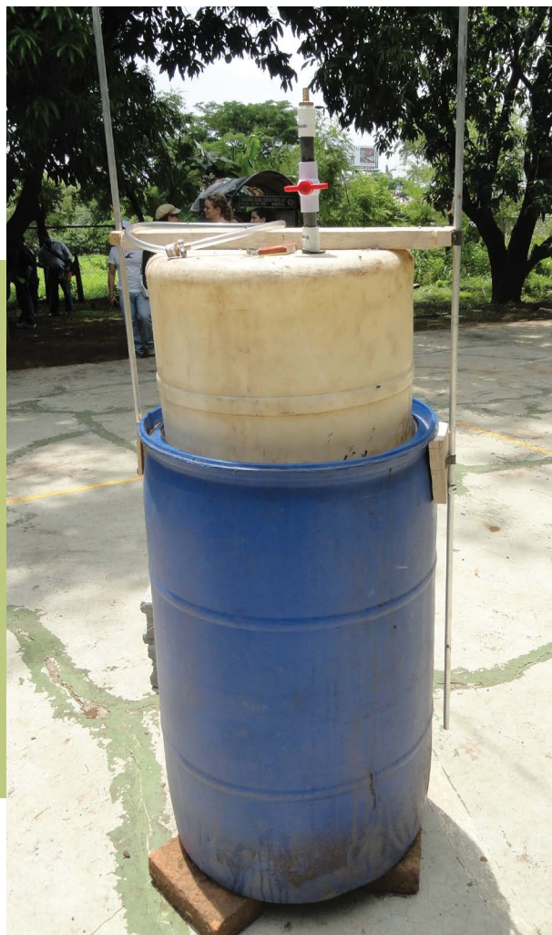
Imagen 9. Diferentes tipos de gasómetros flotantes
