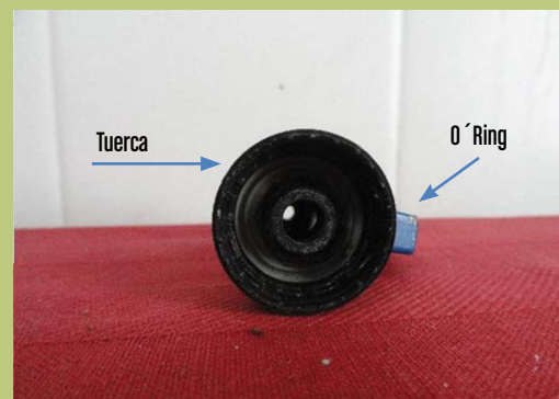
Imagen 36. Sellado de salida de gas para digestor batch de laboratorio
