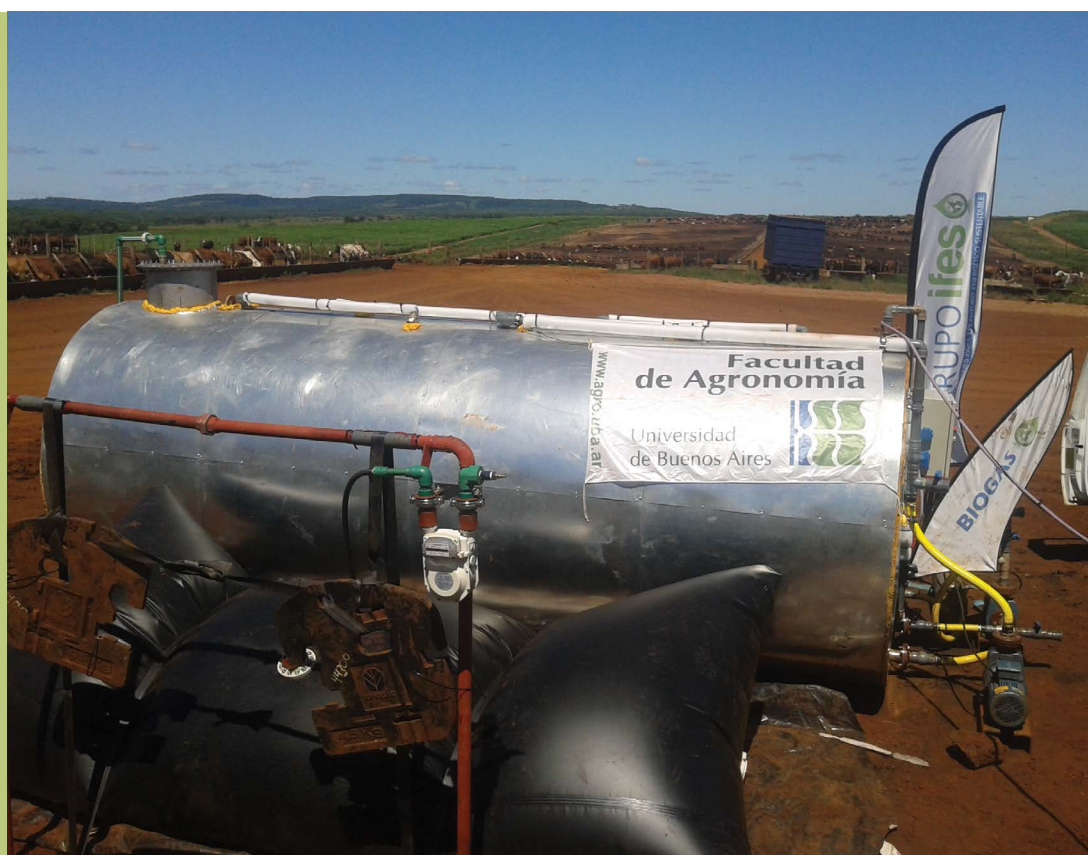
Imagen 30. Gasómetro de membrana de PVC con filtro de sulfhídrico y válvula de seguridad incorporada
