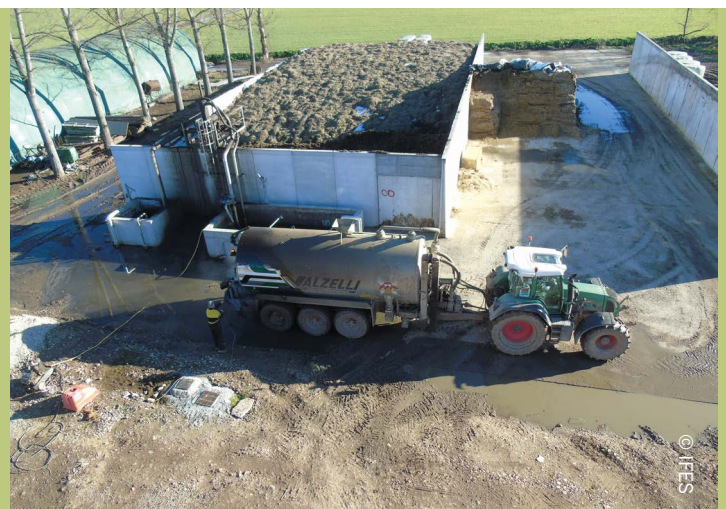
Imagen 15. Segregación de fracciones líquida y sólida con separador helicoidal. Almacenamiento de la sólida
