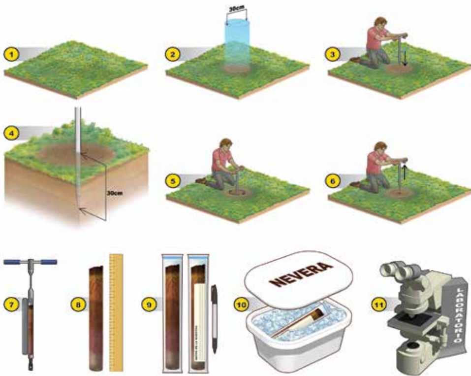
Figura 18. Esquema de cómo se deben sacar las muestras de suelo con el barreno para suelos. Después de enterrar el barreno en el suelo a una profundidad aproximada de 30 cm (1-4), éste se debe girar (5) y sacar del suelo con mucho cuidado (6 y 7). Posteriormente, se mide la profundidad del suelo con una regla (8) y se guarda cada muestra en una bolsa plástica nueva o completamente limpia (9) para ser guardada en una nevera portátil y posteriormente en el congelador (10). Finalmente, se realiza el análisis químico (11).
