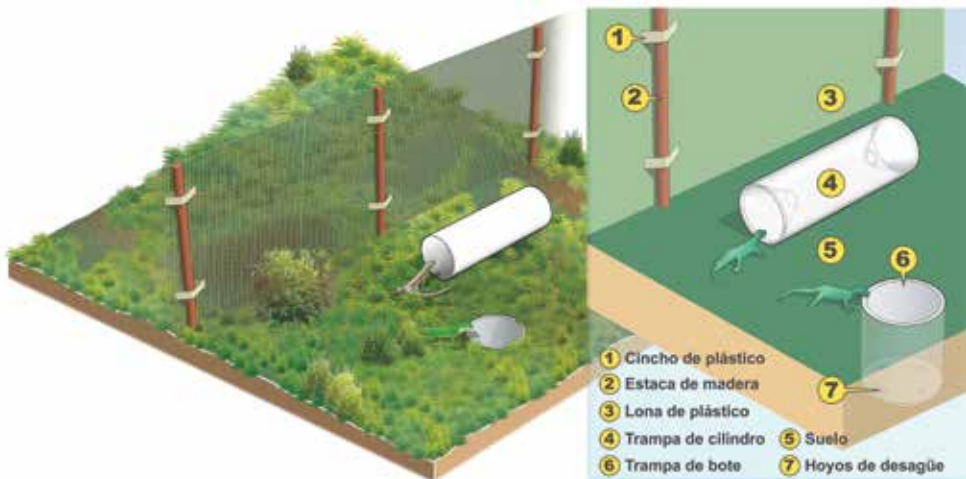
Figura 43. Trampa de caída con valla de desvío.
